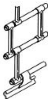
PARTICOLARE DELLA CATENA LATERALE DI GUIDA, PER UNA GARANZIA DI QUALITÀ DEL FUNZIONAMENTO.
