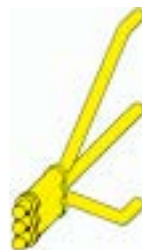
PARTICOLARE TONDINI E LEGACCIO PER MAGLIA CON TRAVEVERSA DI RINFORZO
